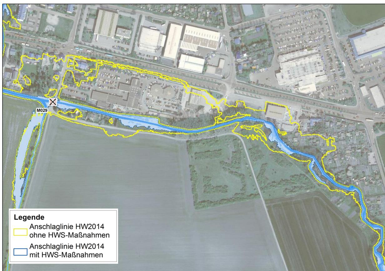
Abbildung 8-19 HW 2014 mit Hochwasserschutzmaßnahmen, Linderbach Weimarische Straße
