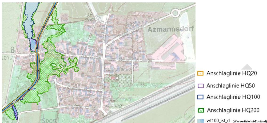
Abbildung 7-16 Ortslage Azmannsdorf, Gewässer Linderbach – Flächenausbreitungen HQ<sub>20</sub> bis HQ<sub>200</sub>
